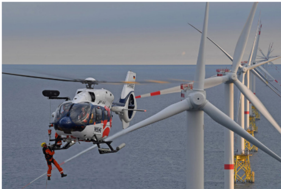
(Photo WIKING HELIKOPTER SERVICE) L'hélicoptère H145 de WIKING HELIKOPTER SERVICE hélitreuille un technicien de maintenance, dans un parc éolien aux larges des côtes du Royaume-Uni
